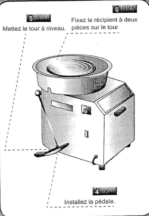
6. Fixez le récipient à deux pièces sur le tour, en le plaçant sous le rebord du support de roulement (sous la girelle).
