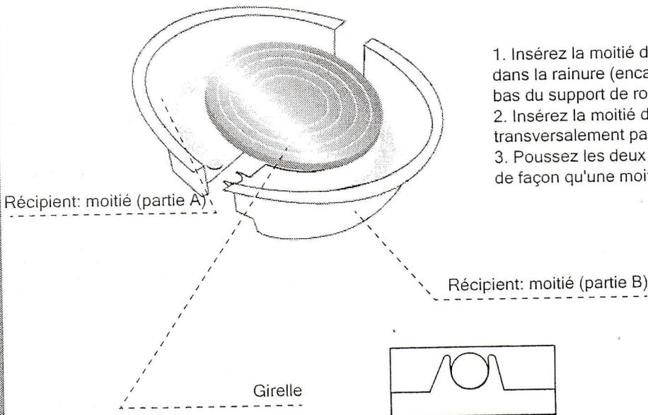
1. Insérez la moitié du récipient (partie A) dans la rainure (encastrement) située en bas du support de roulement.
