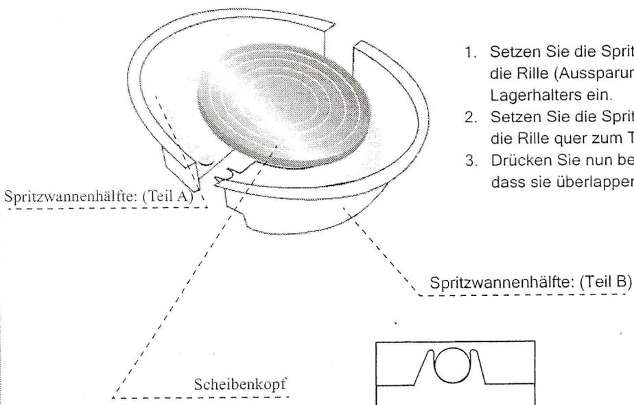
1. Setzen Sie die Spritzwannenhälfte (Teil A) in die Rille (Ausparung) an der Unterseite des Lagerhalters ein.
