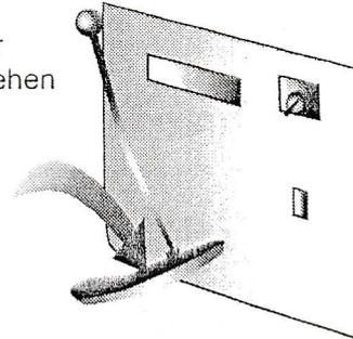
5. Drücken Sie das Pedal nach vorne oder nach hinten, um die Drehzahl zu erhöhen bzw. zu reduzieren. Zum Anhalten des Scheibenkopfs ist das Pedal vollkommen nach hinten zu drücken.
