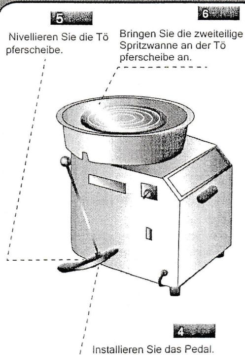
6. Bringen Sie die zweiteilige Spritzwanne an der Töpferscheibe an. Sie muss unter dem Flansch des Lagerhalters aufsitzen (unter dem Scheibenkopf).
